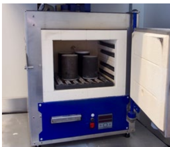
Coloca las cajas de moldeo en un horno de quemado con buena ventilación.
