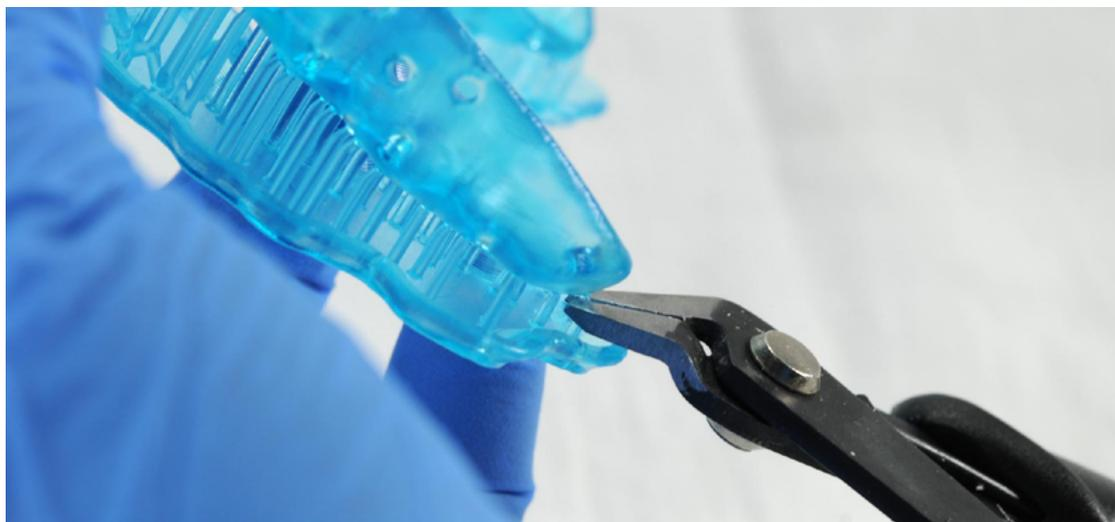
Retira los soportes utilizando un disco de corte y una herramienta de mano u otra herramienta para retirar elementos impresos.
